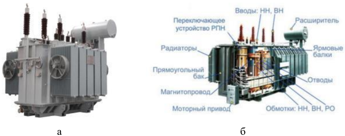
Рис. 2.7. Двухобмоточный трансформатор: а – внешний вид; б – конструктивные элементы
